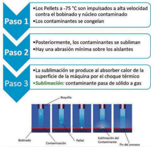
Figura 4. Explicación del proceso de limpieza criogénica.
