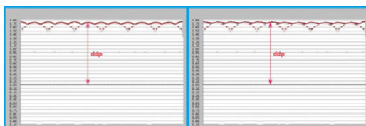
Figura 6 – Tensión de salida de una fuente trifásica de doce pulsos
