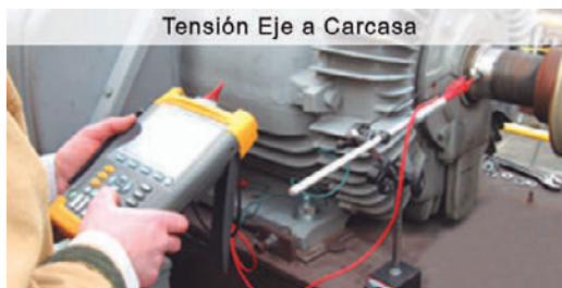
Figura 1. Tensión eje a carcasa
