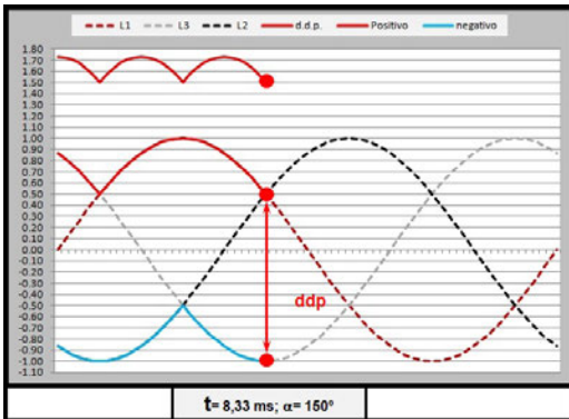
Figura 9 – Valor de tensión continua en el instante t = 8,83 ms
