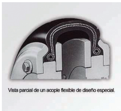
Figura 3. Vista parcial de un acople flexible de diseño especial.
