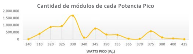
Figura 37. Programa RenovAr. Cantidad de módulos fotovoltaicos por potencia unitaria que se instalarán en Argentina
