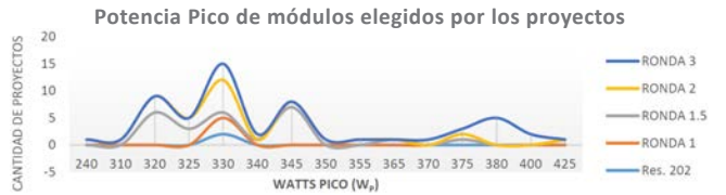
Figura 36. Programa RenovAr. Potencia Pico de los módulos fotovoltaicos utilizados por los Proyectos
