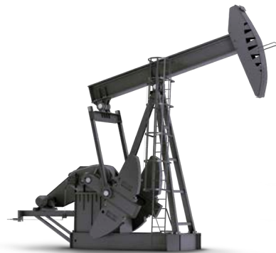
Figura 2 - Estación de bombeo petrolera
